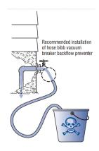
水道の給水管が水道以外の管(井戸水等の管)と接続されていることを誤接合(クロスコネクション)といいます。 例えば一般の庭園などで使われている水まき用ホースが水入りのバケツ、ラジェーター、スイミングプール等の中に入ってそのままにしておくと、水の逆流による水源の汚染が起きてしまいます。 水源を守るため、水まき用ホースを蛇口に取り付ける際は、必ず散水用逆止弁装置(下写真)を取り付けてから使用してください。そして、使用していないときは必ずホースを蛇口から外して下さい。
